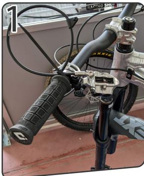
Posizionare la bicicletta sul cavalletto e rimuovere la ruota anteriore. Rimuovere la pinza freno anteriore (e il supporto tubo) e fissarla provvisoriamente al manubrio per proteggerla da eventuali schizzi di olio.
