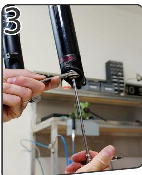
Svita di mezzo giro il dado con la chiave da 19mm per sbloccare la Loctite. Successivamente AVVITARE (in senso orario) il perno centrale con la chiave a brugola da 4mm.
