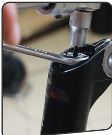
Posizionare entrambi i dadi (puliti e sgrassati) sulle aste e SVITARE (utilizzando una apposita chiave dinamometrica) a 8Nm
