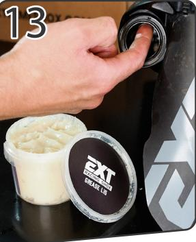
Spalmare una piccola quantità di EXT Grease L1S all'interno degli scrapers, fai attenzione a non esagerare, un sottile film di grasso è sufficiente.
